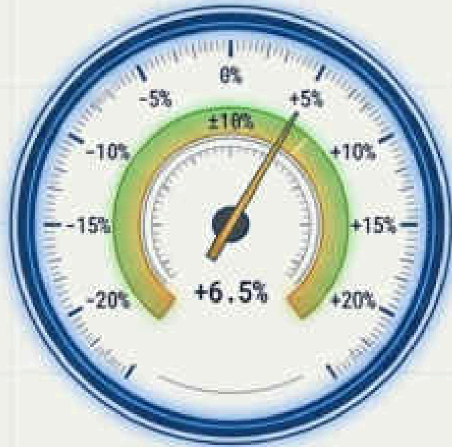
Voltaj Dalgalanması | Limit: \pm 10\% (Nominal Voltaj Üzerinden)
